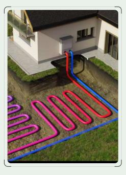
AN ILLUSTRATION OF A GROUND-SOURCE HEAT PUMP SYSTEM USING GEOTHERMAL ENERGY
